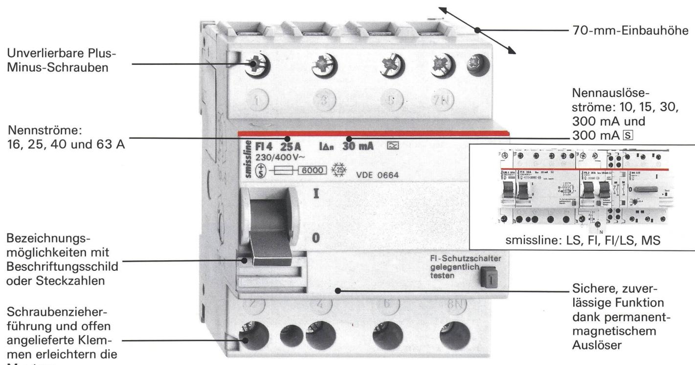
Die neuen smissline-Fehlerstromschutzschalter sind der beste Personen- und Sachschutz für alle neuen und bestehenden Anlagen. Die Abschaltung erfolgt in Sekundenbruchteilen, noch bevor Gefahren für
