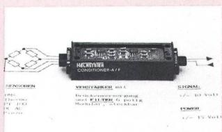
mierbaren Verstärkung von 0,1/1/10/100/1000 sowie ein steckbares 6poliges Antialiasingfilter untergebracht. Zusätzlich ist eine 5-Volt-Geber speisespannungsversorgung integriert. Die Ein-/Ausgänge sind über Binder-Subminiaturschalter zu führen.
