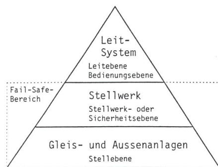
Figur 3 Leitsysteme automatisieren den Betriebsablauf
