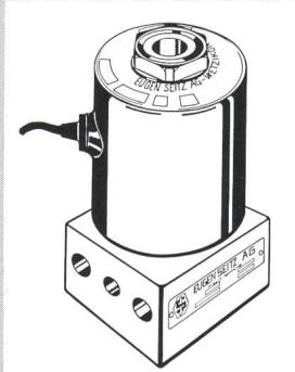
liertem Aluminium oder rostfreiem Stahl gefertigt; als Anschlüsse stehen verschiedene Gewinde oder Flansche zur Auswahl. Beliebige Einbaulage für Rohr- oder Flanschmontage. Die Innenteile bestehen aus rostfreiem Stahl, Weichdichtungen sind wahlweise aus NBR, FKM, EPDM oder PTFE erhältlich. Eine Auswahl von austauschbaren Magnetspulen für Gleich- oder Wechselspannungen von 6 bis 250 V sind in verschiedenen Bauformen und Schutzzarten lieferbar.
