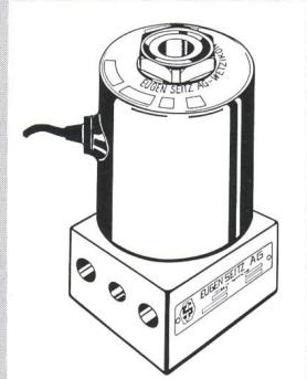
liertem Aluminium oder rostfreiem Stahl gefertigt; als Anschlüsse stehen verschiedene Gewinde oder Flansche zur Auswahl. Beliebige Einbaulage für Rohr- oder Flanschmontage. Die Innenteile bestehen aus rostfreiem Stahl, Weichdichtungen sind wahlweise aus NBR, FKM, EPDM oder PTFE erhältlich. Eine Auswahl von austauschbaren Magnetspulen für Gleich- oder Wechselspannungen von 6 bis 250 V sind in verschiedenen Bauformen und Schutzzarten lieferbar.
