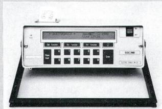
Nach Ablauf der eingestellten Intervallzeit kann auf Wunsch kein Protokoll, ein reduziertes oder das normale Protokoll, nach jedem Tag das normale und am Ende der Messperiode das Gesamtprotokoll ausgedruckt werden. Datum und Zeit sind Bestandteil der Messdaten.
