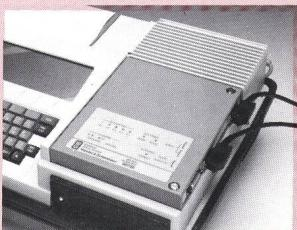
Zum Interface gehört eine leistungsfähige Software, die eine tiefreichende Analyse des D-Kanal-Protokolls ermöglicht. Varianten des D-Kanal-Protokolls sind für diesen Analysator kein Problem. Durch die freie Programmierbarkeit (State-programming, keine Programmierhochsprache erforderlich) sind nationale Un-
