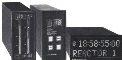
Ein mikroprozessorgesteuerter **Zweikanal-Leuchtband- und Digitalanzeiger** 72 x 144 mm für alle elektrisch messbaren Prozessgrößen einschließlich Thermoelemente und Pt 100 Sonden. Messkreise galvanisch getrennt. Pro Kanal können 2 Grenzwerte gesetzt werden. Alle Parameter sind mittels 3 Tasten konfigurierbar. Die Dioden-Leuchtbalken sind dreifarbig. Option: 11-stufiges Linearisierungsmodul für z.B. die Inhaltsanzeige von liegenden zylindrischen Behältern.
