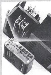
Kleinleistungen zuverlässig schalten. Lieferbar in verschiedenen Ausführungen und mit verschiedenen Kontaktbestückungen. Abmessungen 30×25×12,5 mm. Mechanische Lebensdauer >50×10<sup>6</sup> Schaltspiele.
