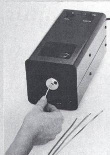
vergleichbar mit einer Revolvrtrommel, mit vier Führungsbohrungen ersetzt sind. Durch Drehen einer seitlich angebrachten Rändelschraube wird das rotierende Messer auf die richtige Isolationsstärke eingestellt. Das Gerät verarbeitet Draht- und Litzenquerschnitte von 0,25 bis 2,5 mm, Abisolier-
