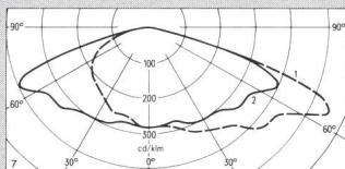
Zusammenwirken von Lampe und Spiegeloptik werden in allen Fällen sehr hohe Leuchtenbetriebswirkungsgrade von 79% bis 83% erreicht. Lampen mit höherer Leistung eignen sich für Anlagen mit Nennleuchtdichten von 1,0 und 1,5 cd/m<sup>2</sup>; für Anlagen mit 0,3 und 0,5 cd/m<sup>2</sup> werden Lampen niedriger Leistungsstufen eingesetzt, z.B. HgL 80 W, NaH 70 W.
