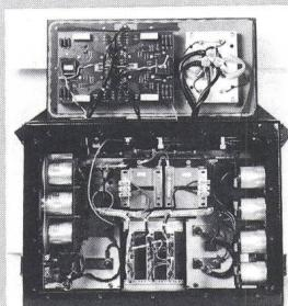
einen Watt bis 10 kW und von einigen Volt bis 1500 VDC. Die Geräte arbeiten mit einer Zwischenfrequenz von 25 bzw. 100 kHz. Das Bild zeigt ein Bordnetzspeisegerät mit Signalübertragung über Lichtleiter zur doppelten Isolation der Bordnetzstromversorgung von Trolleybussen.
