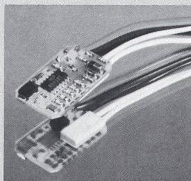
schalter einen elektrischen Kontakt. Die integrierte Elektronik verzögert das Ein/Ausschalten um jede beliebige Zeitspanne zwischen 30 s und 36 h.
