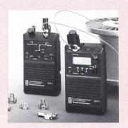
dBm registriert extrem niedrige Pegel am Leitungsende ebenso exakt wie grosse Pegel direkt am Senderausgang des Systems. Die hohe Messgenauigkeit wird beim OLP-2 ohne den sonst üblichen Offsetabgleich erzielt, was den Bedienungskomfort erheblich steigert.
