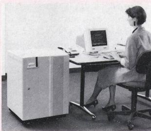
pazität von 172 Stunden Sprachspeicherung, erlaubt 32 gleichzeitige Telefongespräche und kann bis zu 3200 Benutzern eine eigene Mailbox anbieten. Mehrere Systeme können auch weltweit miteinander vernetzt werden. Das GMS wird hinter der Hauszentrale installiert oder direkt an die PTT-Amtsleitungen angeschlossen.
