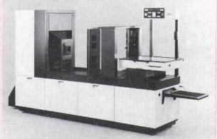
Dank dem automatisch einfahrenden Raster können sowohl sämtliche Strich- wie auch Rasterarbeiten in äusserst kurzer Zeit erledigt werden. Die Tageslichtkamera Eskofot 8250 erlaubt die Herstellung von bis zu 5 Reproduktionen pro Minute.
