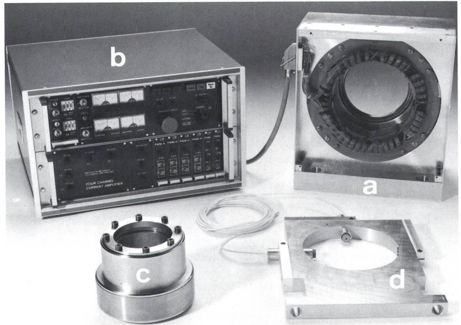
Figur 7 Elektromagnetischer Aktuator ETH-190/50/1 zur Erzeugung von Tastsignalen und zur Dämpfung
