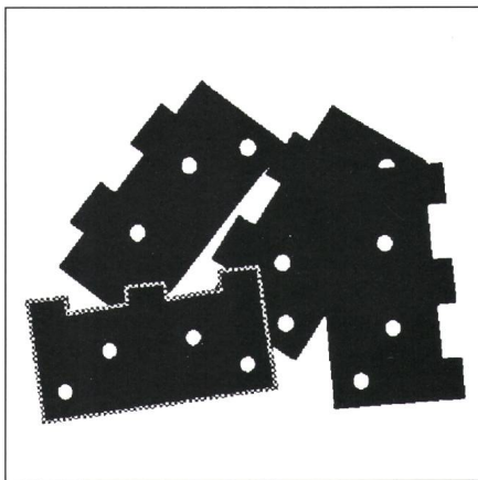
Figur 7 Sich teilweise verdeckende Objekte Ihre Erkennung mit Merkmals-Clustern ist möglich (Objekt unten links; die anderen Objekte sind noch nicht erkannt). Allerdings ist es in diesem Fall prinzipiell unmöglich, festzustellen, welches der überlappenden Objekte oben, welches unten ist.
