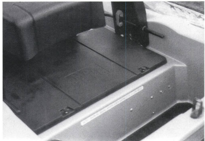
Die (Not-)Sitzbank des Mini-el für ein Kind, mit Blick nach hinten. Darunter befinden sich der Antrieb und die Batterien
