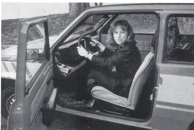
Gutes Raumangebot im Larel für Fahrer und Beifahrer; die Bedienelemente entsprechen weitgehend dem konventionellen Basisfahrzeug
