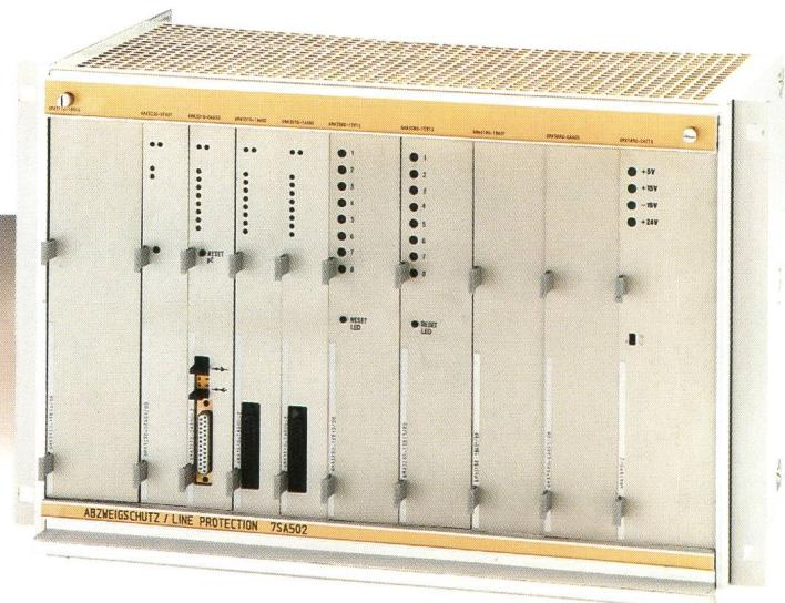
**Der mikroprozessorgeführte Selektivschutz 7S** besteht aus Stationsschutz und Abzweigschutz. Der Stationsschutz mit dezentralen und zentralen Intelligenzen sorgt für Sammelschienen- und Schaltversagerschutz. Der Abzweigschutz verfügt neben der Basisfunktion Distanzschutz über die Zusatzfunktionen Wiedereinschalten, Fehlerortung, Erfassen/Speichern von Kurzschlussdaten und Betriebsmessung.
