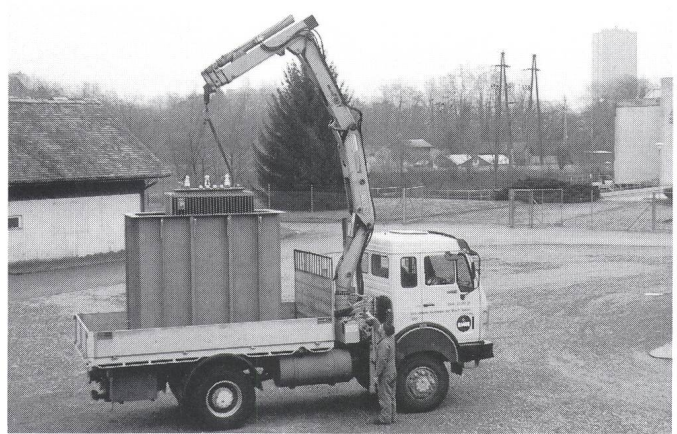
Figur 2 Strassentransport eines PCB-Transformators in einer Spezialwanne
