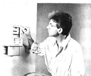
usw. Die Kassierstation kann auch ausser Betrieb genommen werden. Dann arbeitet das Gerät wie ein normaler Elektrizitätszähler.
