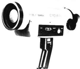
len. Mit Hilfe dieses Gerätes können Stromversorgungsunternehmen mögliche Störstellen in Verteilernetzen vom Boden oder aus der Luft orten. Die Temperatur von Kabelverbindungen, Isolatoren und Schaltern sowie von überhitzten Lagern, Buchsen usw. lässt sich über einen Bereich von  $-20$  bis  $+400^{\circ}\text{C}$  mit  $\pm 1\%$  Genauigkeit messen.
