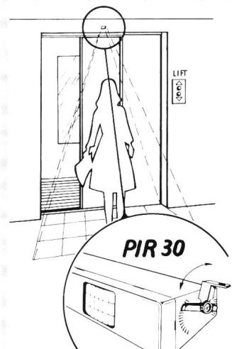
oder Elektronik-Ausgang und verschiedenen Betriebsspannungen. PIR 30 eignet sich besonders auch für die Kabinenvorraumkontrolle bei Aufzügen (Bild): Wartezeiten vor geschlossenen Türen können verringert, plötzlich sich schließende Türen vermieden werden. Eine Variante «Gong» dient zur Erfassung eintretender Personen bei offenen Ladentüren und Durchgängen.
