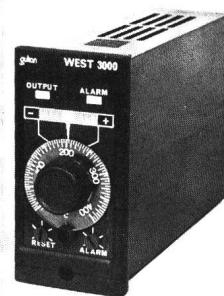
zur Verfügung. Die Geräte sind mit arretierbarem Drehknopf für die Sollwerteingabe, mit zweifarbigem Abweichungsanzeige sowie mit spritzwasserdichter und staubdichter Frontplatte ausgerüstet. Am Ausgang steht ein Relaiskontakt oder ein Logiksignal zur Ansteuerung von Halbleiterrelais zur Verfügung. Zusätzlich wird ein Alarmkontakt angeboten.
