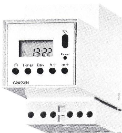
Einfachste Programmierung mit nur 6 Tasten. Tages- und Wochenprogramm. 12 Speicherplätze für max. 84 Schaltbefehle. 6 mm LCD Anzeige. Schaltleistung 16 A 250 V.
