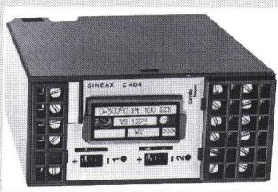
Das Gerät wird im Anreihgehäuse zum Aufschnappen auf Schienen geliefert. Die Anschlussklemmen befinden sich gut zugänglich auf der Frontseite. Als Hilfsenergie lässt sich Wechselspannung 50/60 Hz oder verschiedene Gleichspannungen verwenden.
