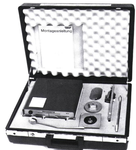
Figur 7 Beispiel eines Diagnostik-Sets für die Kontrolle des Kontaktzustandes, ohne den Leistungsschalter öffnen zu müssen
