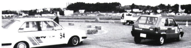
Der VW Jetta mit Natrium-Schwefel-Batterie setzt zum Überholen des CKW «Larel» an, im Hintergrund ein «Elestra»
