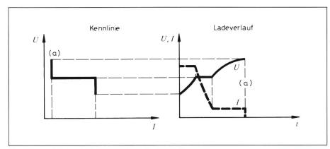
Figur 4 Geregeltes Ladeverfahren mit Konstant-Kennlinie
