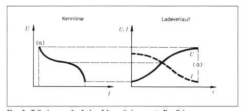
Figur 3 Teilweise geregeltes Ladeverfahren mit eingegrenzter Kennlinie
