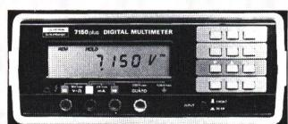
für 1 Jahr liegt bei 0,008% (80 ppm). Wechselspannungsseitig gibt es einen zusätzlichen 0,2-V-Bereich bei 1  $\mu\text{V}$  Empfindlichkeit, und die Bandbreite beträgt 3 Hz bis 1 MHz. Der crest-Faktor beträgt 10:1. Als weitere Ergänzung ist eine Temperaturmessfunktion von  $-200^\circ\text{C}$  bis  $+600^\circ\text{C}$  vorhanden. Zur Standardausrüstung gehören auch das IEEE-488-Interface und eine Drucktaste für einen Front/Rear-Messeingang.
