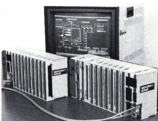
der Prozessindustrie, Fabrikationsautomatisierung, Transportanlagen, Energieerzeugung und -verteilung, Gas- und Wasserwerken, Entsorgungsanlagen, Haustechnik usw. einsetzen. Das neue Sescreen ist flexibel ausbaubar und kann jederzeit mit Ihrer Anlage wachsen. Die Verbindung zum Prozess übernimmt eine serielle Standard-Schnittstelle (RS 232) und gewährleistet die volle Kommunikationsfähigkeit.
