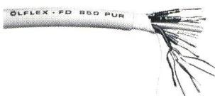
(0,07 mm) sind mit einem speziellen PVC isoliert. Der ganze Aderbund ist in kurzen Schlaglängen in Lagen versetzt, talkumierte und mit einem Textilband umwickelt. Ein neu entwickelter PVC-Aussenmantel unterstützt die Beweglichkeit und verhindert, insbesondere bei den Typen 850FD und 850FD-CY, ein gegenseitiges Aneinanderhaften mehrerer Leitungen. Zudem sind alle Typen mit Cu-abgeschirmtem Mantel lieferbar.
