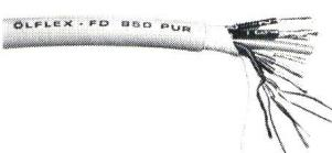
(0,07 mm) sind mit einem speziellen PVC isoliert. Der ganze Aderbund ist in kurzen Schlaglängen in Lagen versetzt, talkumierte und mit einem Textilband umwickelt. Ein neu entwickelter PVC-Aussenmantel unterstützt die Beweglichkeit und verhindert, insbesondere bei den Typen 850FD und 850FD-CY, ein gegenseitiges Aneinanderhaften mehrerer Leitungen. Zudem sind alle Typen mit Cu-abgeschirmtem Mantel lieferbar.
