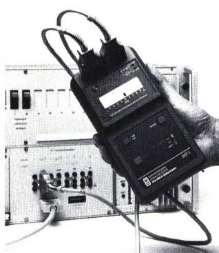
Der Kennzeichentester kann für die Installation und Wartung von Nachrichten-Übertragungssystemen im mobilen Einsatz verwendet werden.
