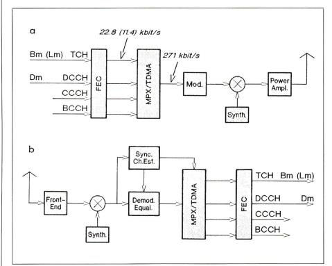
Figur 6 Blockschaltbild der Funkübertragung
