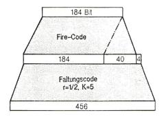
Figur 9 Codierung für Signalisierdaten
