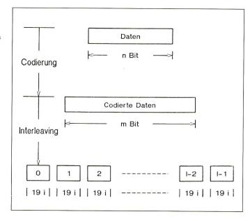
block bestehend aus n Bit in einen neuen Block aus m binären Codesymbolen codiert. Wegen der besondern Struktur des Datenbursts muss m ein ganzzahliges Vielfaches von 19 sein. Nach einer Verschachtelung (Scrambling) werden diese in I Gruppen, deren Anzahl Bit wiederum ein Vielfaches von 19 sein muss, aufgeteilt. Diese I Gruppen werden nun mittels I Datenbursts übertragen. Die Grösse I bezeichnet man auch als Interleaving-Tiefe.
