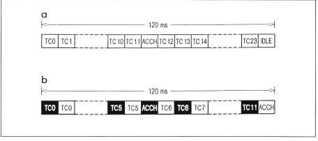
Figur 11 Struktur des Multiplexrahmens (Superframe)
