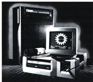
Hilfe von Ikonen und Falschfarben Inspektionsbefehle eingeben. Zur Messung eines Durchmessers zum Beispiel erscheint an der entsprechenden Stelle auf dem Prüfobjekt eine symbolische Schiebelehre.
