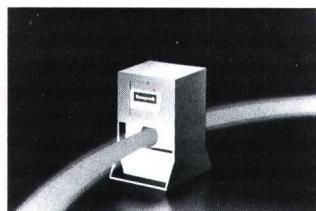
nimalen Leistungsverlusten eine hohe Messgenauigkeit von  $\pm 2\%$ . Der Stromleiter wird dabei durch einen offenen Ferritring geführt. Sein Magnetfeld erhöht die magnetische Flussdichte am Messfühler, dem linearen Hallsensor LOHET (Linear Output Hall Effect Trans-
