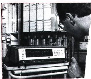
len der Kabel-, Richtfunk- und Satellitenübertragung bzw. an den elektrischen Schnittstellen optischer Übertragungseinrichtungen die erforderlichen Messungen durchführen zu können, ist eine Vielzahl wählbarer Bitraten, Bewertungsfilter und Schnittstellencodes vorgesehen. Unabhängig von der verwendeten Bitrate werden Jitter-Messungen an Takt- und Datensi-
