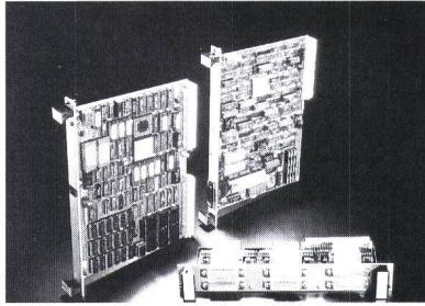
Auch VMEbus-Systeme können mit X.25-Schnittstellen ausgerüstet werden. Das Bild zeigt den X.25-Communication-Controller MVME333X25 mit der Controller-Platine, dem sogenannten Transition-Modul und dem X.25-Softwarepaket.
