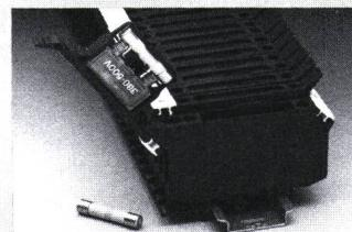
ohne Kennmelder gemäss DIN 41 668. Die Sicherung wird in herausgeklappter Stellung in den Trennhebel eingesetzt, der im geschlossenen Zustand voll in das Anschlussgehäuse eintaucht. Die Leuchtanzeige zur Signalisierung der defekten Sicherung lässt sich jederzeit nachrüsten. Die Klemme besitzt den wendbaren Universalfuss zur Reihung auf allen gängigen Tragschienen. Mehrere Trennhebel können mit einem Verbindungsstift gekoppelt werden, so dass sich z. B. Drehstromkreise gemeinsam schalten lassen.
