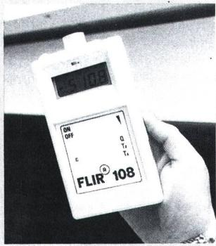
Mit der Referenzmessung wird anschliessend der k-Wert eines Materials berechnet. Das Gerät hat einen Temperaturmessbereich von 0 bis 199,9 C. Der Wärmestrom wird im Bereich von  $\pm 1999 \text{ W/m}^2$  angezeigt. Bei der Wärmestrommessung wird die Umgebungstemperatur automatisch kompensiert. Die kleinen Abmessungen von  $164 \times 80 \times 39 \text{ mm}$  und der Betriebserlaubt eine flexible Anwendung in der gesamten Industrie, der Baubranche, der Chemie usw.
