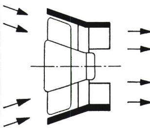
strom und einen geringeren Geräuschpegel. ANSON hat einzelne Prinzipien, wie sie im Strahlturbinenbau längst gebräuchlich sind, übernommen und auf die Kleinventilatortechnik übertragen. Die Ventilatoren haben einen kegelförmigen Axialflügel und ein kegelförmiges Lufteintrittsgehäuse. Der kegelförmige Ansaugteil läuft in einem zylindrischen Ausblasteil über, in welchem rundum angeordnete Leitflächen für einen wirbelfreien Luftaustritt sorgen.
