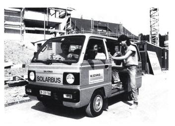
Die Solaranlage dient über das Netz auch zum Aufladen eines Elektro-Personalbusses, einer Eigenkonstruktion, die 4 bis 6 Personen aufnehmen kann und eine Reichweite von 50 bis 100 km hat.
