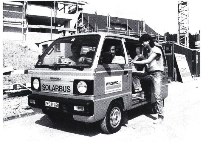
Die Solaranlage dient über das Netz auch zum Aufladen eines Elektro-Personalbusses, einer Eigenkonstruktion, die 4 bis 6 Personen aufnehmen kann und eine Reichweite von 50 bis 100 km hat.
