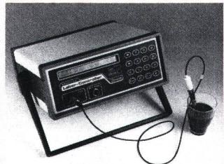
verschiedene Zwecke einsetzen. Die Bedienung von ULC 3000 erfolgt im Dialog-Verfahren über den LCD-Display und die Folientastatur. Alle eingegebenen Parameter bleiben bis zur nächsten Änderung gespeichert.
