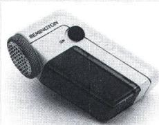
riebetriebene Kleiderrasierapparat arbeitet mit rostfreien Stahlklingen, die in hoher Drehzahl rotieren. Das Gitter am Scherkopf schützt das Gewebe. Die Fusseln werden im durchsichtigen, abnehmbaren Behälter aufgefangen.
