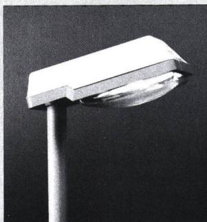
für den Vorschaltgeräteraum. Das Tragelement ist aus Aluminiumdruckguss, die Abdeckhaube aus klarem Kunststoff. Die Konstruktion ist geeignet für eine universelle Mastbefestigung für Aufsatzmontage (60 oder 70 mm Ø) oder Ansatzmontage (42-60 mm Ø). Die Geräteplatte lässt sich werkzeuglos auswechseln.
