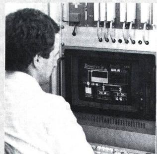
zessdaten, unterstützt grafische Darstellungen und speichert die Prozessdaten, so dass sie weiterverarbeitet werden können. Die Programmierung des Gerätes ist menügeführt und erfordert keine besonderen Kenntnisse. Das Leitsystem ist modular aufgebaut, lässt sich mit den Anforderungen vergrößern und benutzt als Hard- ware die standardisierten Computer.
