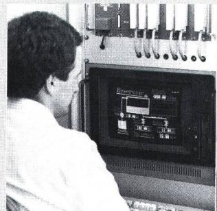
zessdaten, unterstützt grafische Darstellungen und speichert die Prozessdaten, so dass sie weiterverarbeitet werden können. Die Programmierung des Gerätes ist menügeführt und erfordert keine besonderen Kenntnisse. Das Leitsystem ist modular aufgebaut, lässt sich mit den Anforderungen vergrößern und benutzt als Hard- ware die standardisierten Computer.
