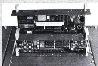
handenen Bedienelementes (z.B. Bildschirmterminal) erforderlich. Für grössere Objekte lassen sich die Kapazitätsgrenzen des Gerätes erweitern. Der Generatorschutz Typ GC91 verfügt über eine Selbstüberwachung, ist einfach in der Bedienung und kompatibel mit allen Leittechniken.
