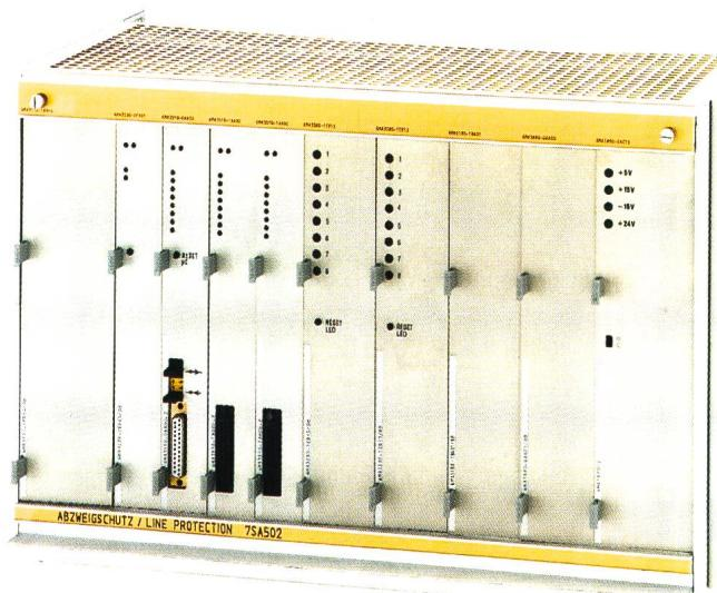
**Der mikroprozessorgeführte Selektivschutz 7S** besteht aus Stationsschutz und Abzweigschutz. Der Stationsschutz mit dezentralen und zentralen Intelligenzen sorgt für Sammelschienen- und Schaltversagerschutz. Der Abzweigsschutz verfügt neben der Basisfunktion Distanzschutz über die Zusatzfunktionen Wiedereinschalten, Fehlerortung, Erfassen/Speichern von Kurzschlussdaten und Betriebsmessung.
