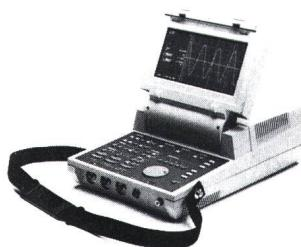
Abtastrate, 8 kByte-Akquisitionsspeicher, 204 KByte-RAM-Disk, 8 bit-Vertikalauflösung, 10 ns-Glitchdetektor und 100 MHz Bandbreite. In der RAM-Disk können bis zu 99 Signale oder 99 Geräteeinstellungen unverlierbar abgelegt werden.
