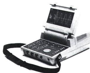
Abstrakte, 8 kByte-Akquisitionsspeicher, 204 KByte-RAM-Disk, 8 bit-Vertikalauflösung, 10 ns-Glitchdetektor und 100 MHz Bandbreite. In der RAM-Disk können bis zu 99 Signale oder 99 Geräteeinstellungen unverlierbar abgelegt werden.
