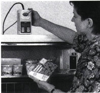
**Seit kurzem stellen zahlreiche Elektrizitätswerke Interessente leihweise ein handliches Messgerät zur Verfügung, mit dem der Stromverbrauch einzelner Geräte kontrolliert werden kann.**
