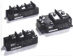
von Frequenzumrichtern und unterbrechungsfreien Strom-versorgungen (USV) sowie in getakteten Stromversorgungen für das Elektroschweißen. Die Leistungstransistoren sind für Dauergrenzströme im Bereich von 25-300 A und Sperrspannungen von 600-1200 V ausgelegt. Hohe Verstärkungsfaktoren ( $H_{FE}$  100...) vereinfachen die Ansteuerung. Die Transistor sind im bewährten Modulgehäuse aus Kunststoff potentialfrei aufgebaut.
