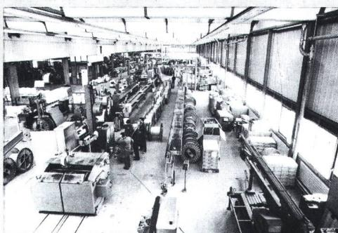
vernetzten Aderisolierung mit X- und G-Eigenschaften hergestellt. Das dafür verwendete Polyolefin-Copolymerisat ist weich, montagefreundlich und trotzdem zug- und schlitzfest. Radox-Isolation bietet Gewähr für höhere Alterungsbeständigkeit und Strombelastbarkeit.
