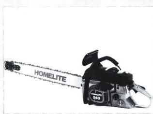
bremse sorgen für zusätzliche Sicherheit. Der Kraftstofftank umfasst 0,85 l, jener für Öl 0,6 l. Lieferbar mit verschiedenen Schwertlängen.
