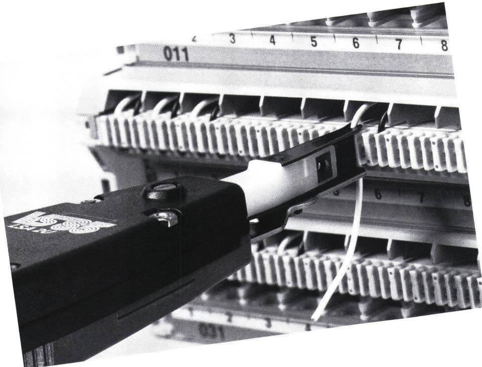
Der Entwurf für das wegweisende Konzept des VS 83 stammt von der PTT. Reichle+De-Massari AG erhielt den Entwicklungsauftrag und realisierte – in enger Zusammenarbeit mit den verschiedenen Fachdiensten der PTT – das gesamte Programm bis zur Serienreife.
