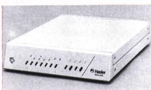
statistischen Multiplexer an, den Omnimux 2000, mit Aggregatgeschwindigkeit bis 256 kbit/s, bis max. 304 Ports zu 19 200 bit/s asynchron. Anwendung: für Inhouse- oder für Datenfernübertragung.
