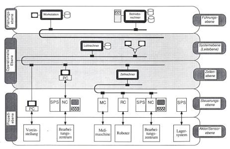
Figur 3 Prinzipielle Systemarchitektur der Fertigungsleittechnik.
