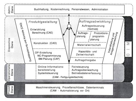
Figur 1 Systemarchitektur der verschiedenen EDV-Funktionen eines Betriebes.
