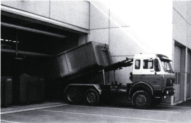
Figur 2 Aufladen der mit Schlamm beladenen Container
