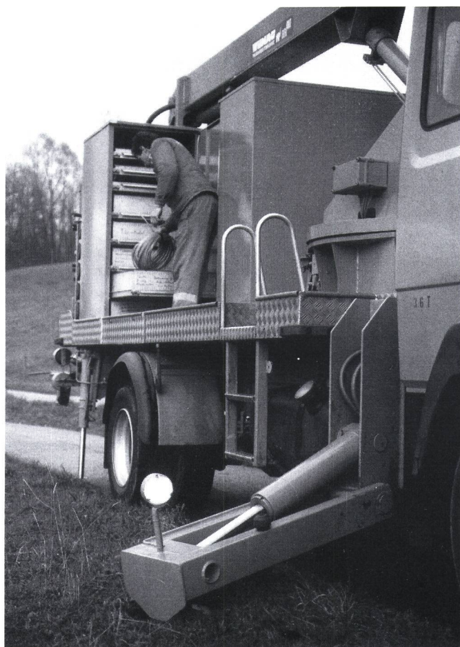
Figur 4 Mercedes-Lastwagen mit hydraulischen Stützen und Werkzeugkästen
