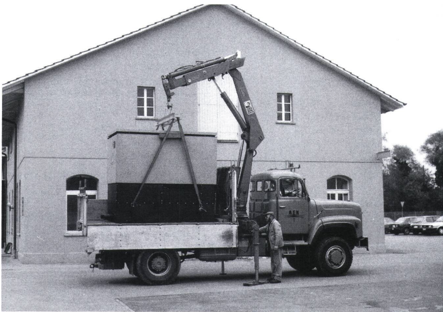
Figur 1 Lastwagen beim Verlad einer vollständig ausgerüsteten Compact-Transformationsstation (Gewicht 4,5 Tonnen) mit hydraulischem Kran.
