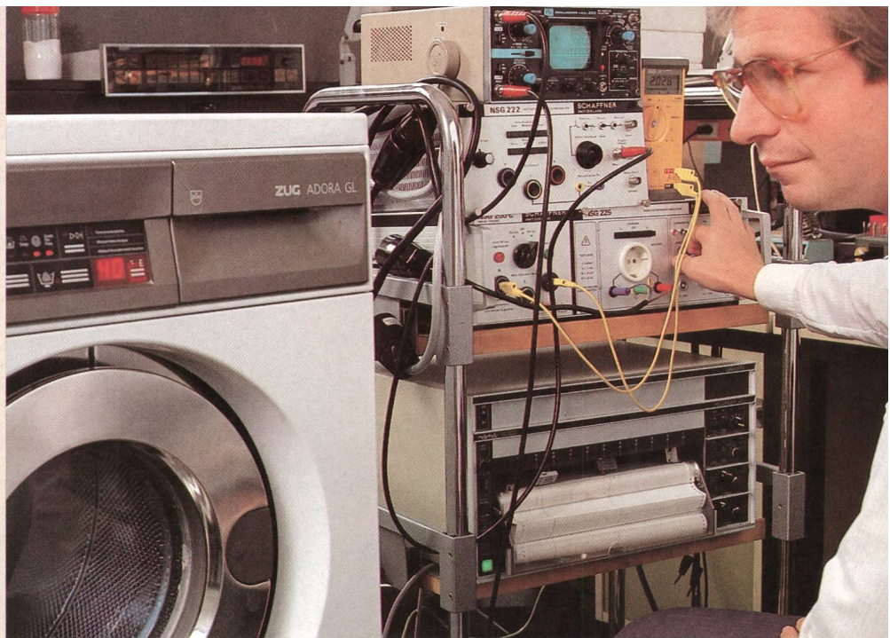
Controllo di disturbi elettromagnetici sui componenti elettronici
