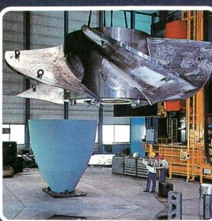
**Standardisierte S-Turbine** für 3130 kW bei 22,7 m Fallhöhe (Fourth Lake, CDN), im Werk Bell, Kriens.
