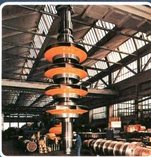
Eine von 6 **Francisturbinen** mit 340 000 kW Einheitsleistung für das Kraftwerk Karakaya (Türkei).
