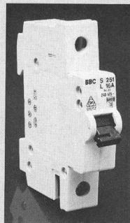
Die neuen Sicherungsautomaten bestehen aus zwei Reihen: S250 für Hausinstallationen, S270 für Industrie sowie Hausinstallationen. Die ein- und mehrpoligen Geräte sind in den Charakteristiken L, V und K lieferbar. Nennstromstärken L und V 6 - 32 A, K 0,5 - 40 A.
