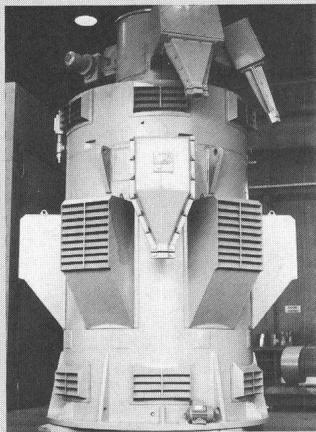
in Zusammenarbeit mit Wälzlagherstellern entwickelt wurden. Vertikal angeordnete Motoren für besonders hohe Axialkräfte haben ein Traglager, das die hydraulischen Drücke der Pumpe und das Gewicht der Pumpenwelle sowie der Laufräder aufnimmt. Das Traglager ist mit einem Axial-Pendelrollenlager und einem Schräkgugellager bestückt. Im Bild ein Drehstrommotor mit Schleifringläufer, 2650 kW, 6000 V, 600 t/min, Wälzlagierung, Axialschub 153 kN.
