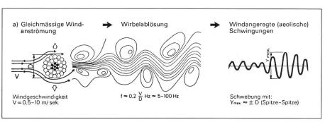
Figur 1 Mechanismus der Seilschwingungen
