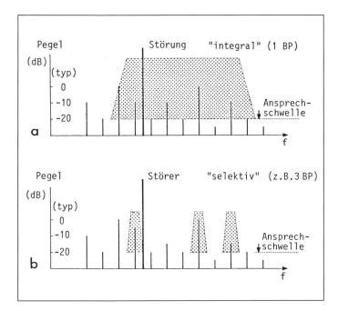
Figur 3 Auswirkung eines Störers bei integraler Messung (a) und selektiver Messung (b)
