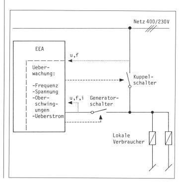
Figur 1 Typische dezentrale Energieerzeugungsanlage (EEA) mit Überwachungseinrichtung
