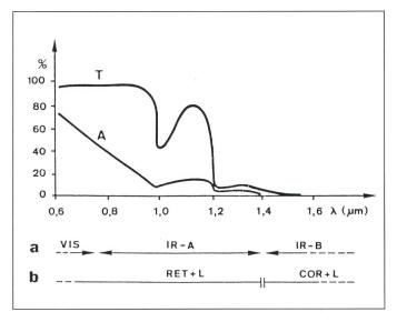
Figur 3 Transmission und Absorption des Auges
