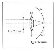
Figur 2 Optisches Ersatzbild des menschlichen Auges
