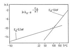
Figur 6 Ausfallrate  $\lambda$  in Funktion der Temperatur für zwei verschiedene Anregungsenergien  $E_{\Lambda}$
