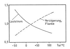
Figur 5 Relative Parameter-Verschlechterung eines IC bei zunehmender Temperatur
