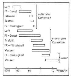
Figur 9 Wärmeübergangskoeffizient für verschiedene Kühlmedien
