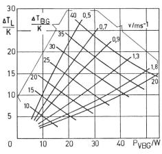
Figur 8 Temperaturerhöhung eines Leiterplattenstapels in Funktion der Verlustleistung bei verschiedenen Luftströmungsgeschwindigkeiten
