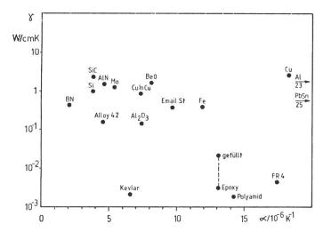
Figur 10 Wärmeleitung-Wärmedehnung-Diagramm für verschiedene Materialien
