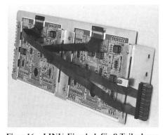
Figur 16 LINU-Einschub für 8 Teilnehmer mit Frontplattenanzeige
