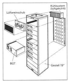
Figur 11 **Aufbau eines Gestells**
