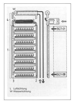
Figur 12 Kreislauf des R11-Kühlmediums mit Luft- oder Wasser-Wärmetauscher
