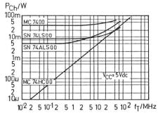
Figur 4 Chipleistung  $P_{Ch}$  in Funktion der Taktfrequenz  $f_T$
