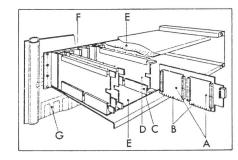
Figur 14 Baugruppenträger und Einschub
