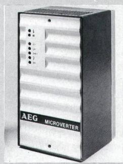
stor-Pulsumrichtergeräte arbeiten blindleistungsarm aufgrund des Diodeneingangs. Der Ausgang ist sinusmoduliert für eine günstige Motorausnutzung und für gute Rundlaufeigenschaften; er ist kurzschluss- und erdschlussfest. Die Geräte haben einen außerordentlich günstigen Wirkungsgrad; Energieüberspeisung ergibt sich durch den Zusatzaufbau Brems-Chopper.
