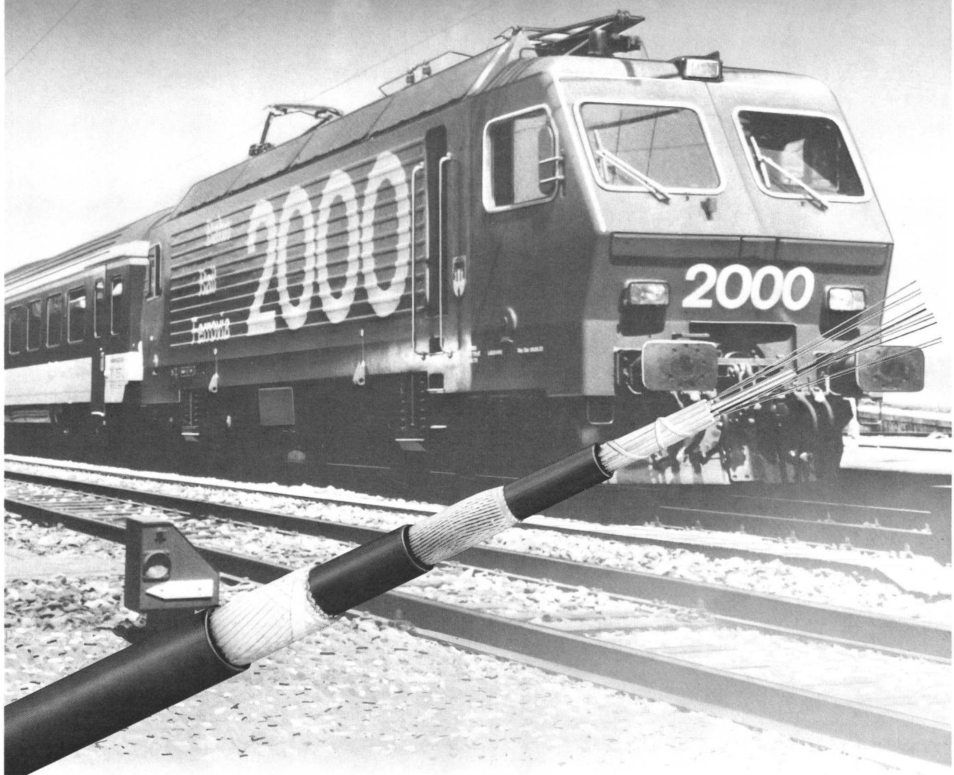
Entlang der Schienen in einer störbeeinflussten Umgebung verlegt, sind Bahnkabel für Nachrichtenzwecke den vom Schienenerverkehr herrührenden elektromagnetischen Einwirkungen ausgesetzt.
