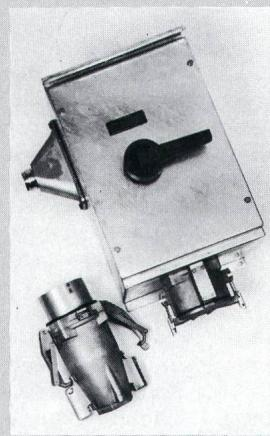
Die Spannungs-Codierung entsprechend IEC 309 gewährleistet, dass nur Paarungen gleicher Nennspannung möglich sind. Versilberte Tulpenkontakte und Käfigklemmanschlüsse von 70 mm<sup>2</sup> bis 240 mm<sup>2</sup> sorgen für sichere Stromübertragung.
