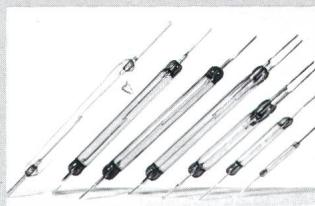
spannungskontakten mit einer Spannungsfestigkeit bis zu 14 kV DC und Schaltspannungen bis zu 10 kV AC/DC. Diese Kontakte sind aufgrund eines schaltbaren Stromes bis 3 A auch als Hochlastschalter bis 50 W/VA einsetzbar. Mit den Form-C-Kontakten lassen sich bei einer Spannungsfestigkeit bis 1000 V Ströme bis zu 1,5 A bei 30 W/60 VA schalten.
