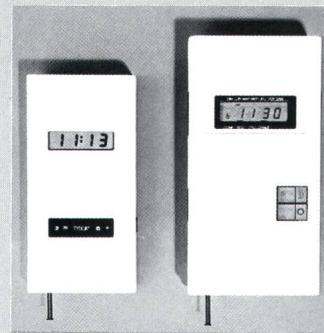
Tybox wird über drei 1,5-V-Standard-Batterien gespeist, die das Gerät über ein Jahr lang versorgen und jede durch einen Stromausfall im Netz verursachte Unregelmässigkeit in der Programmierung ausschalten. Nennleistung auf Heizungsseite: 5 A/220 V.
