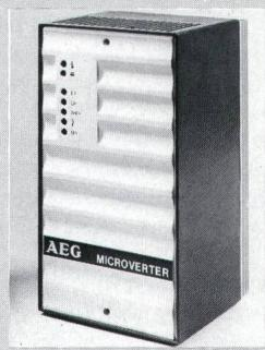
stor-Pulsumrichtergeräte arbeiten blindleistungsarm aufgrund des Diodeeingangs. Der Ausgang ist sinusmoduliert für eine günstige Motorausnutzung und für gute Rundlaufeigenschaften; er ist kurzschluss- und erdschlussfest. Die Geräte haben einen außerordentlich günstigen Wirkungsgrad; Energieüberspeisung ergibt sich durch den Zusatzaufbau Brems-Chopper.
