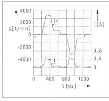
Figure 16 Vitesse et courant du moteur du cœur artificiel
