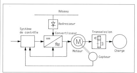
Figure 1 Système d'entraînement électrique
