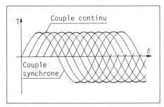
Figure 6 Couple du moteur à courant continu
