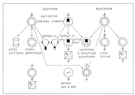
Figure 2 Structuration des principaux moteurs électriques
