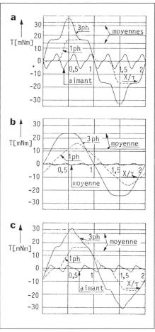
Figure 12 Caracteristique de couple d'un moteur à courant continu sans collecteur
