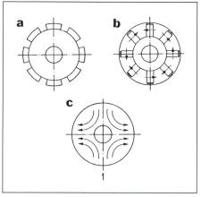
Figure 7 Structure du rotor synchrone
