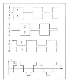
Figure 8 Etats logiques d'un pont à 6 transistors et tension résultante
