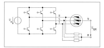
Figure 14 Dispositif de détection de l'harmonique 3  $U_{NM}$  = tension
