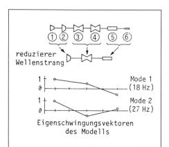
Figur 5 Wellenstrangreduktion auf ein Drei-Massen-Drehschwingungssystem
