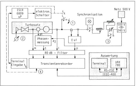
Figur 7 Versuchsanordnung zur Messung dynamischer Vorgänge
