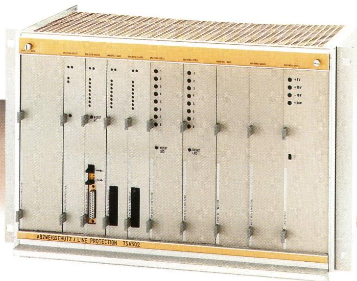
**Der mikroprozessorgeführte Selektivschutz 7S** besteht aus Stationsschutz und Abzweigsschutz. Der Stationsschutz mit dezentralen und zentralen Intelligenzen sorgt für Sammelschienen- und Schaltversagerschutz. Der Abzweigsschutz verfügt neben der Basisfunktion Distanzschutz über die Zusatzfunktionen Wiedereinschalten, Fehlerortung, Erfassen/Speichern von Kurzschlussdaten und Betriebsmessung.
